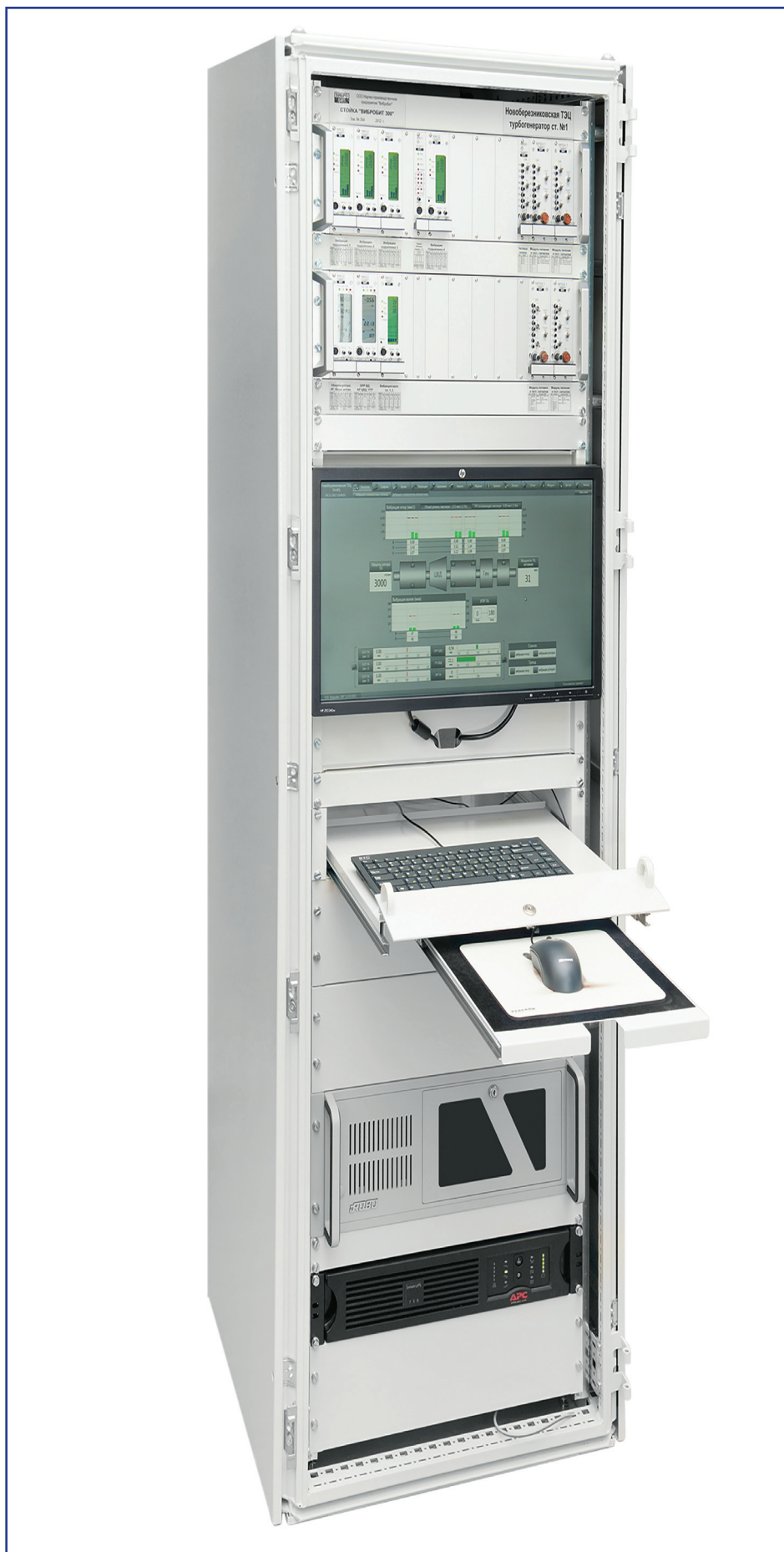
Внешний вид стойки АСКВМ с модулями аппаратуры «Вибробит 300» и промышленным сервером с ПО верхнего уровня
