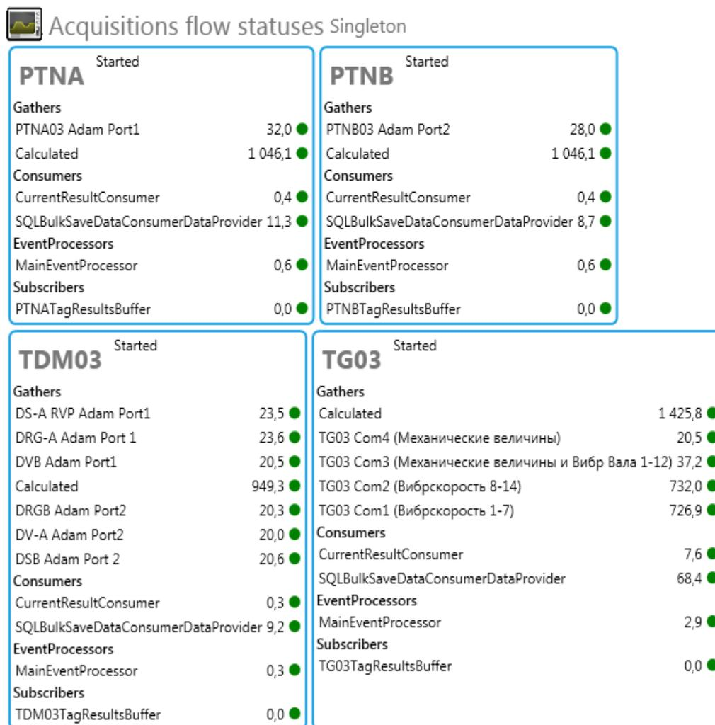
Рис. 38 – Окно диагностического модуля просмотра состояние сборщиков данных.
