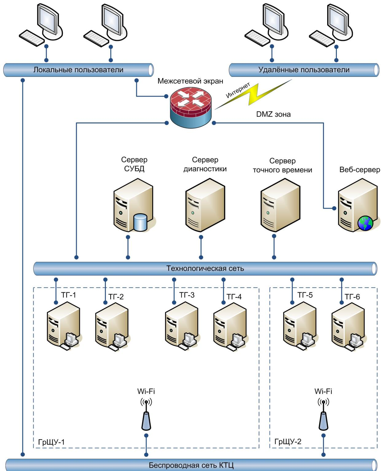
Рис. 1 – Структурная схема системы «Вибробит Web.Net.Monitoring»
